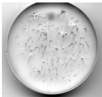
Рисунок 3 – Фотография картины, образующейся в образце из плавленого кварца после серии облучений электронным пучком.
