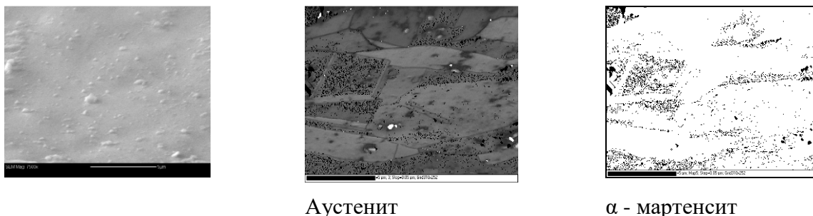
Рис. 1 Карта фаз, снятая в режиме EBSD, \times 7500 для образца стали 12Х18Н10Т, облученного ^{84}\text{Kr} флюенсом \Phi = 1 \cdot 10^{15} ион/см 2 (шаг сканирования 0,05 мкм)
